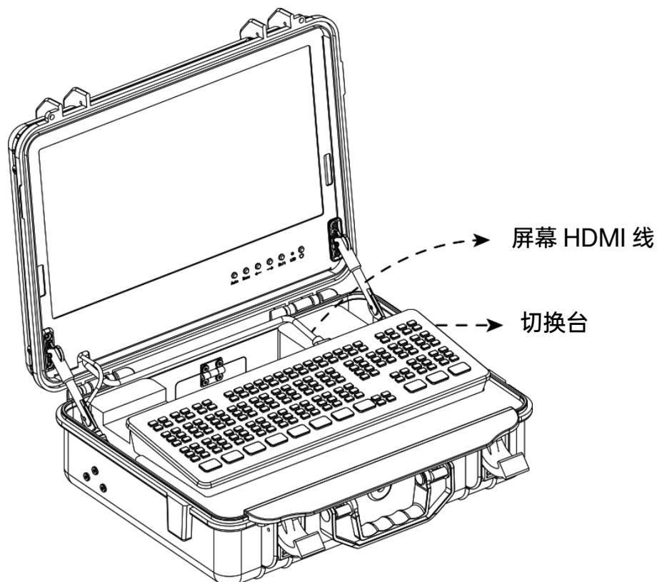
注:SDI 版本的切换台,可先将屏幕 HDMI 线连接到 SDI 转 HDMI 转换器 HDMI 接口上,另一端连接切换台 SDI。
